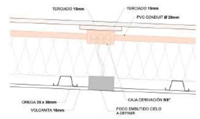
DETALLE FOCOS EMBUTIDOS CIELO 1:5
