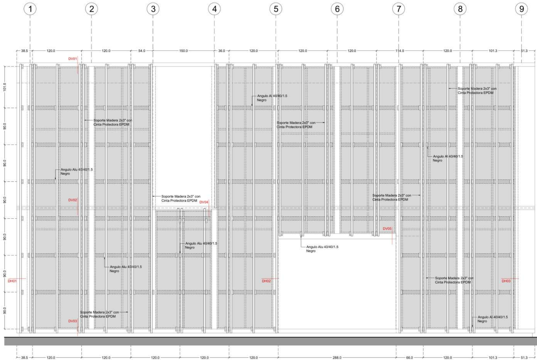
Detalle Fachada - Soportes Verticales Madera
